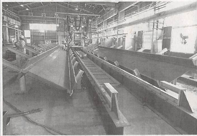
玉野工場に新設したビルトHラインの一部
