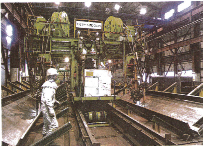
桂スチールが自社開発した国内最大級の自動溶接装置
