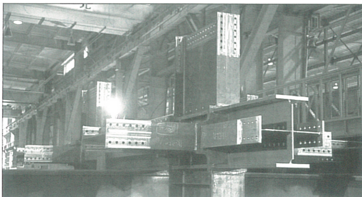
主力製品の「溶接H形鋼」。同社では特注品として顧客の要望に合わせた厚みや形状に加工している
