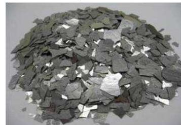
写真：ストリップキャスト法で製造したネジウム鉄ボロン磁石合金鋳片
