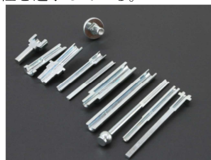
写真：冷間鍛造による一次加工品の切断サプル（鍍金処理後）サプルを縦に切断している。
