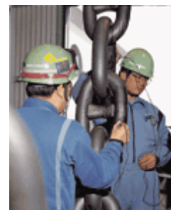
写真：超音波探傷検査
